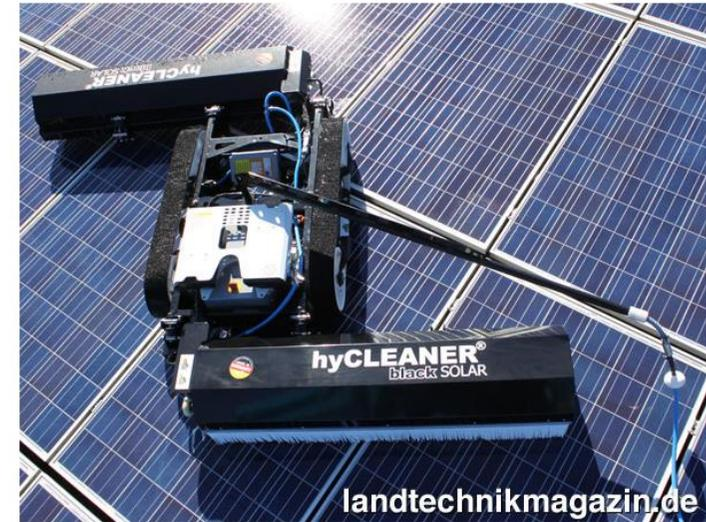
Der neue hyCLEANER black SOLAR facelift von TG hyLIFT lässt sich mit einer zweiten Reinigungsbürste ausstatten und erreicht so bis zu 2,40 m Arbeitsbreite.
