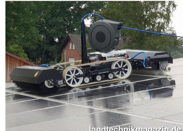
Das Reinigungssystem TG hyLIFT hyCLEANER black SOLAR facelift lässt sich durch ein Seil sichern, das an sieben Punkten befestigt werden kann.
