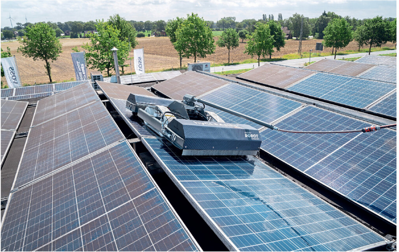
Auf der Messe CMS Berlin 2023 vorgestellt: Ein kompakter, batteriebetriebener Reinigungsroboter für die Trocken- und Nassreinigung kleinerer Solaranlagen auf dem Dach.
