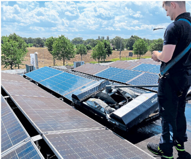
OBEN: Leichte Komponenten von maximal zehn Kilogramm Gewicht lassen sich schnell auf das Dach bringen, wo anschließend alle fünf Teile ineinandergesteckt werden.
